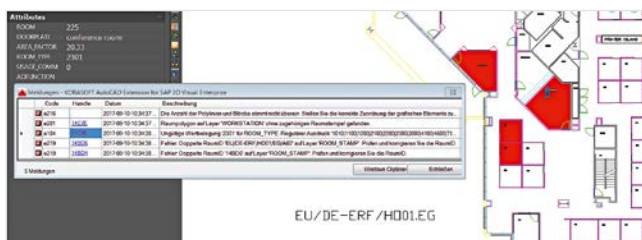
Auflistung von Verstößen gegen BIM-Regeln in einem 2D-Plan
