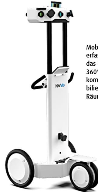
Mobiles Datenerfassungsgerät, das einen digitalen 360°-Scan einer kompletten Immobilie inklusive aller Räume ermöglicht.
